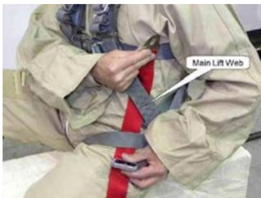
Figura 8. Sujeción de doble punto y doble atadura para asientos de piso orientados hacia atrás
